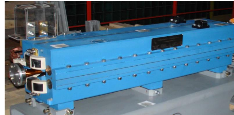
Магнит бустера NSLS II – аналог магнита для «СКИФ»
