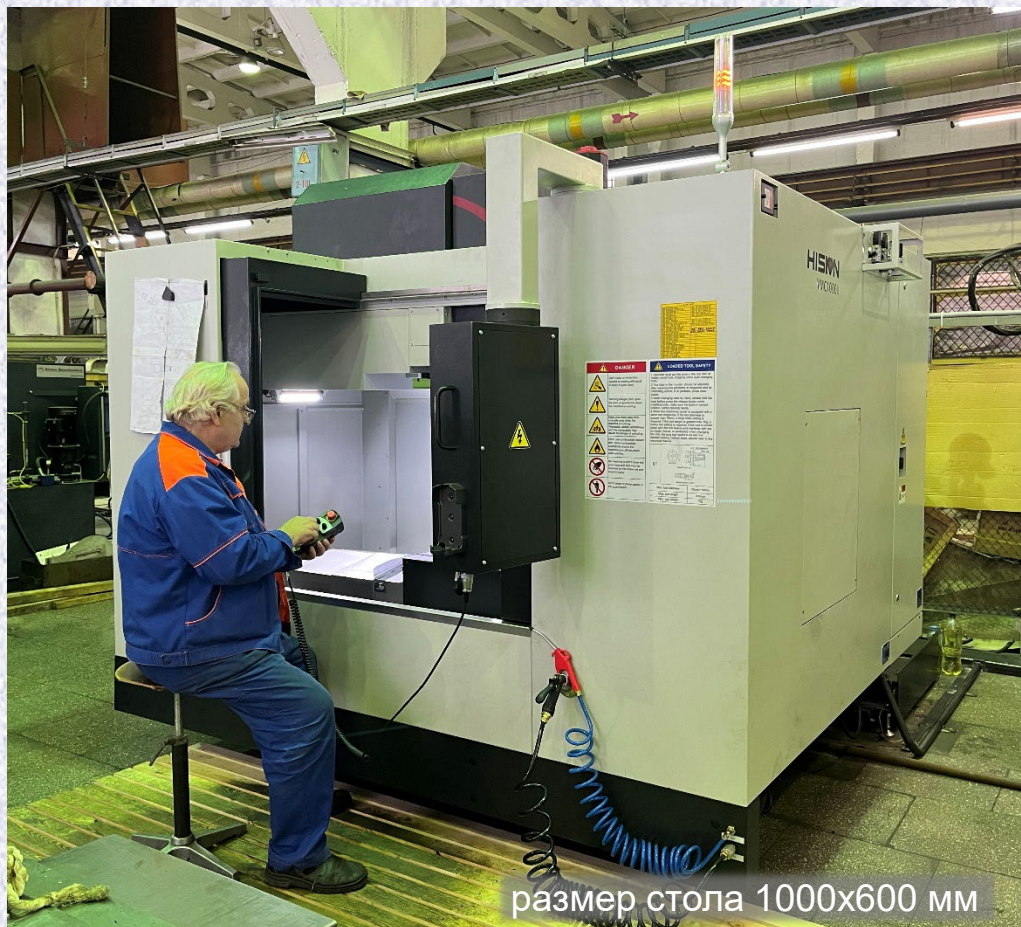
Вертикально-фрезерный обрабатывающий центр HISION VMC1000 II (Китай)
