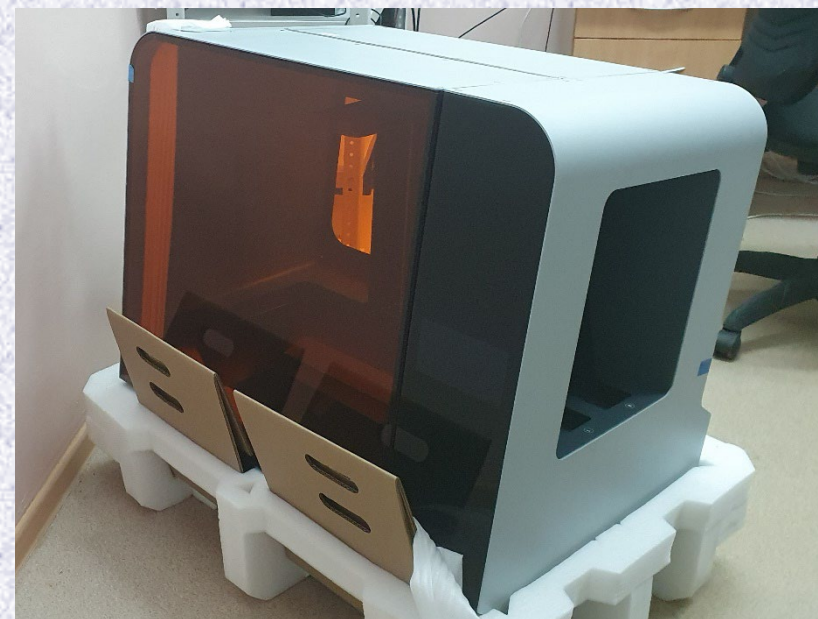
Фотополимерный принтер FORMLABS FORM 3L, область печати: 335x200x300мм.
