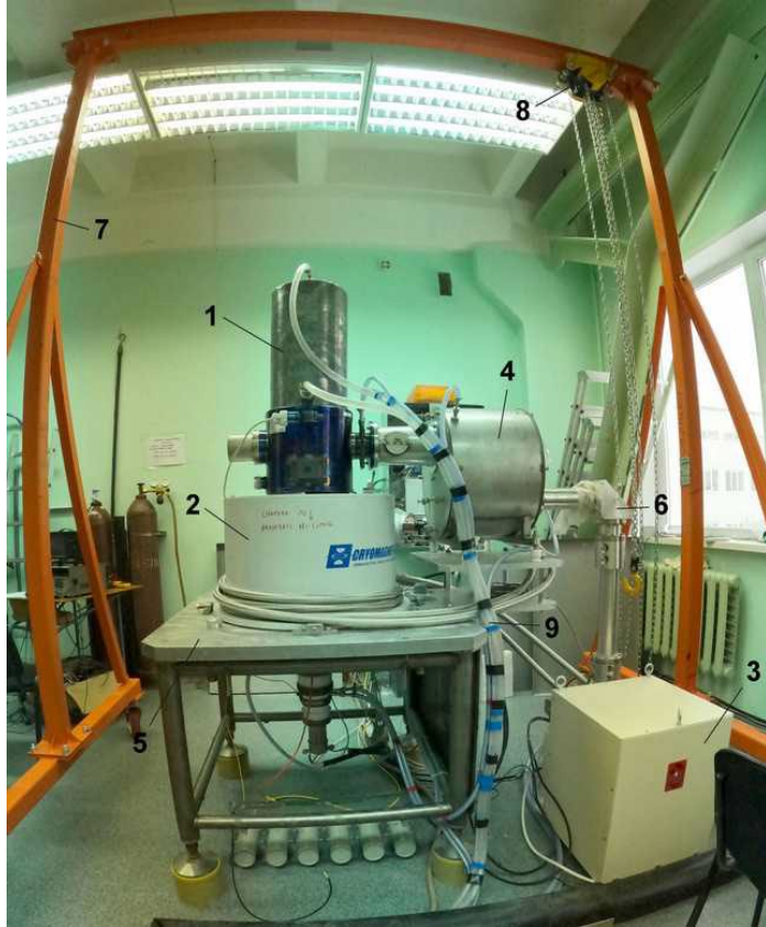
1 – гиротрон; 2 – криомагнит; 3 – компрессор; 4 – система согласующих зеркал; 5 – стол; 6 – волноводный тракт; 7 – козловой кран; 8 – ручная таль; 9 – водяное охлаждение
