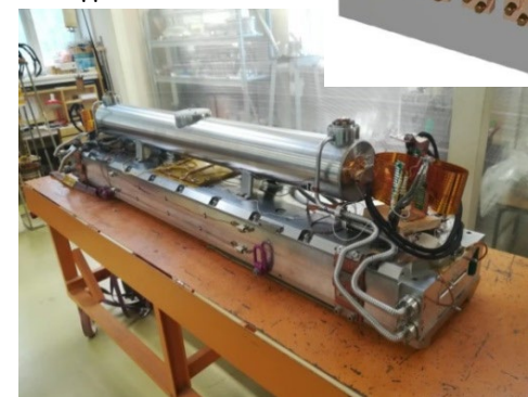
Магнитная система сверхпроводящего ондулятора в сборе
