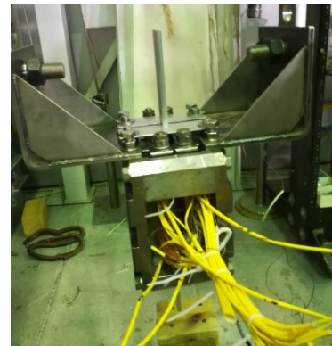
Сборка короткого прототипа для испытания в жидком гелии
