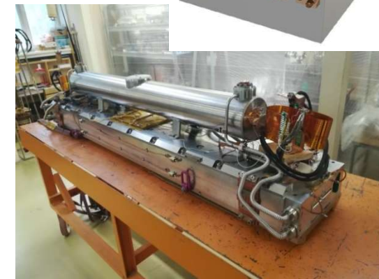
Магнитная система сверхпроводящего ондулятора в сборе
