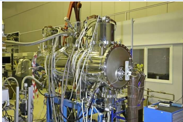
Внешний вид криостата ондулятора в процессе магнитных измерений
