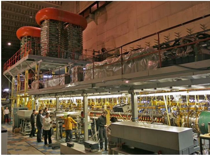
Установка ГОЛ-3 ( T_e \approx 2-4 кэВ, T_i \approx 2-3 кэВ, \tau_E \approx 1 мс, n \approx 10^{15} см ^{-3} ).
