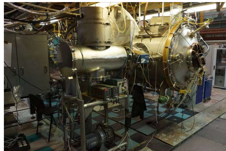
бак плазменной пушки и пост откачки
