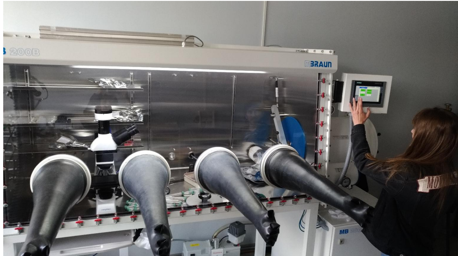
Комната 320, здание 20 Стенд напыления лития Перчаточный бокс LABmaster pro (MBraun, Германия) с металлографическим микроскопом
