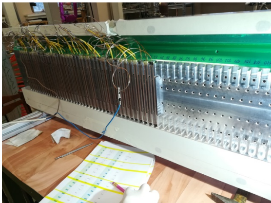
Этапы сборки полноразмерного сверхпроводящего ондулятора.
