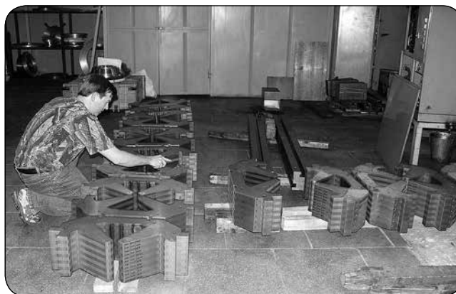
А. А. Старостенко — проверка качества склейки половинок квадруполь. Фото А. Цыганова.
