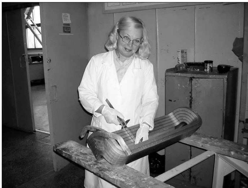
Проверка качества выпускаемой продукции — забота бюро испытаний и контроля. Специалисты осуществляют пооперационный контроль деталей и ведут соответствующую документацию. На снимке: Татьяна Турикова, контролер участка склейки.
