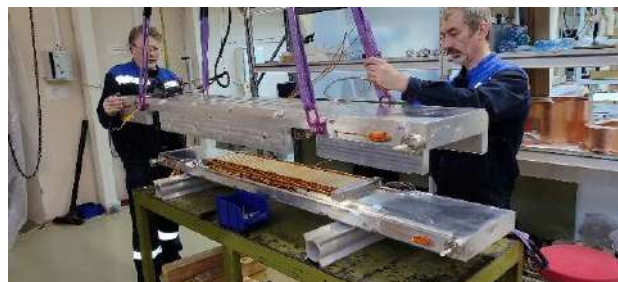
Рисунок 1. Магнитная система сверхпроводящего вигглера с полем 4,5 Тл и периодом 48 мм для станции 1-5 в процессе сборки.
