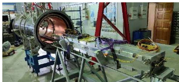
Рисунок 2. Процесс сборки 148-полюсного вигглера с полем 2,7 Тл и периодом 27 мм для станции 1-3 в собственном криостате косвенного охлаждения.
