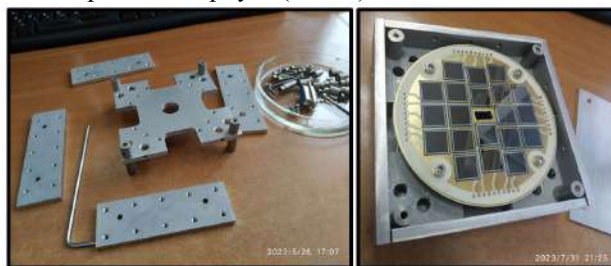
Рисунок 9. Корпус РМД перед началом сборки и в собранном виде с платой чувствительных элементов.
