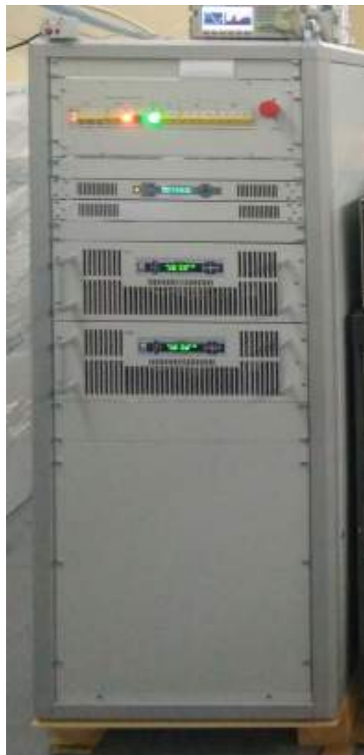
Рисунок 5. Прототип усилителя ВЧ-2.
