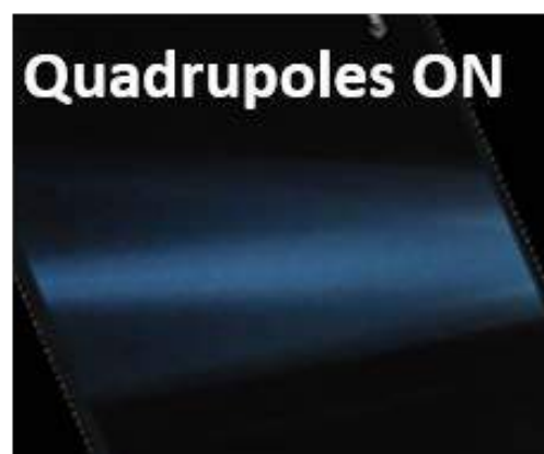
Рисунок 6. Демонстрация эффективности сжатия пучка в области калориметра при помощи квадрупольных магнитов.
