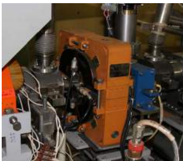
Рисунок 32. Квадрупольная согласующая линза, установленная на линейном ускорителе ИК.
