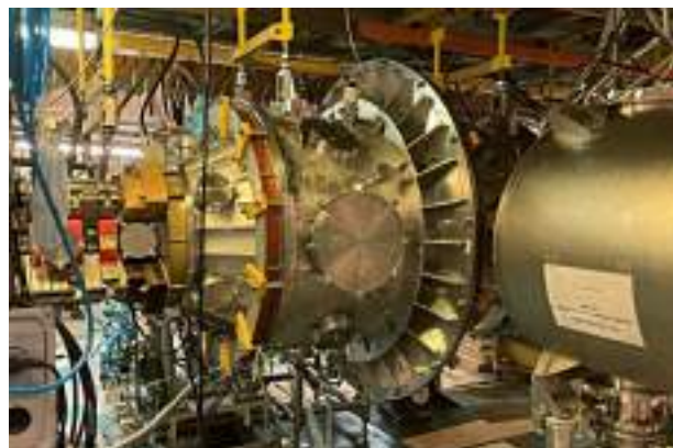
Рисунок 8. Центральная ловушка и часть секции сильного поля. В правой части кадра – перезарядный бак нагревного инжектора № 2. Большое окно в камеру предназначено для модуля вакуумной откачки.
