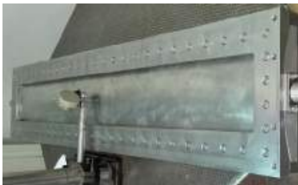
Рисунок 5. Измерение деформации танталовой пластины конвертора в процессе гидравлических испытаний.
