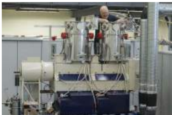
Рисунок 3. Ламповые модули мощного выходного каскада третьего ВЧ генератора.
