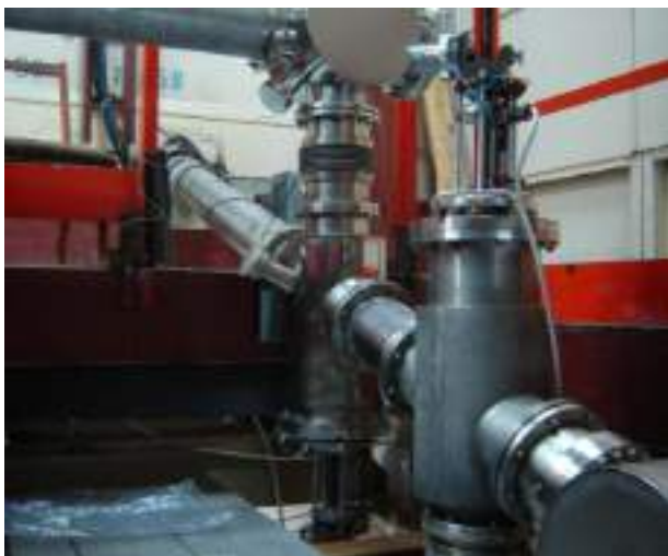
Рисунок 5. Система переключения излучения от разных ЛСЭ. Излучение всех ЛСЭ выводится на одни и те же пользовательские станции. Переключение между ЛСЭ осуществляется за счёт убирающихся зеркал.
