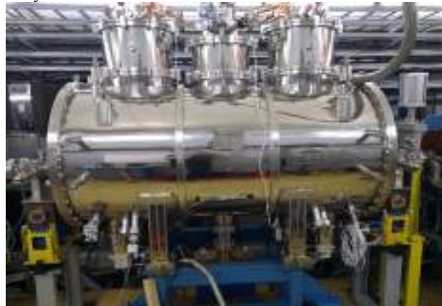
Рисунок 1. 54-полюсный вигглер с полем 3 Тл и периодом 48 мм, установленный на Курчатовском источнике синхротронного излучения.
