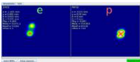
Рисунок 8. Изображение поперечного профиля электронного (слева) и позитронного (справа) пучков.
