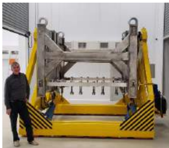
Рисунок 5. Фотография кантователя экваториального порт-плага в чистом помещении для сборки порт-плагов. Масса порт-плага в сборе около 50 тонн.
