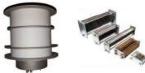
Рисунок 17. Псевдоискровой тиратрон ТПИ-10к\50 и линейка SOS-диодов.
