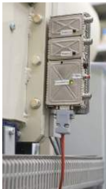
Рисунок 6. Система защиты каскадов от самовозбуждения на нерабочих частотах.
