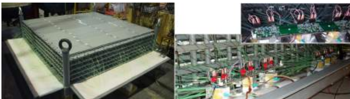
Рисунок 4. Нижнее плечо адронного сэндвича, смонтированные кремниевые фотоумножители, малошумящие предусилители.
