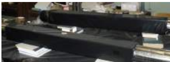
Рисунок 5. Сцинтилляционные счетчики верхнего \Delta E/E слоя на столе сборки. Сцинтилляторы обернуты черной бумагой, фотоумножители помещены в пермалловые экраны.
