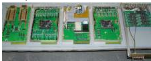
Рисунок 2. Образцы модулей новой электроники. Слева-направо: ВЦП для дрейфовых камер; ВЦП для сцинтилляционных счетчиков; КАМАК контроллер с встроенным микрокомпьютером; ВЦП с для МППК; быстрый 8-канальный дискриминатор.
