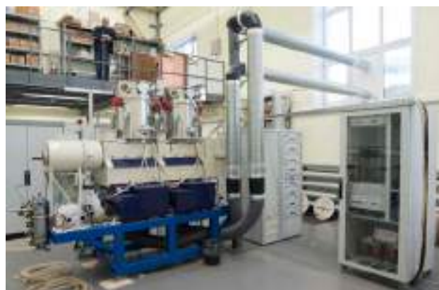
Рисунок 7. Стенд для испытаний нового ВЧ генератора.
