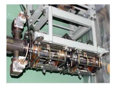
Fig.(5.2)9. VEPP-4M longitudinal feedback system.
