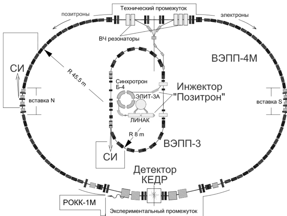
Рисунок 2.1. Схема ускорительного комплекса ВЭПП-4М с детектором КЕДР
