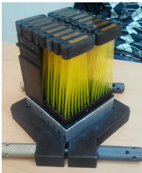
Рисунок 65 – Вид блоков кристаллов со спектросмещающими волокнами
