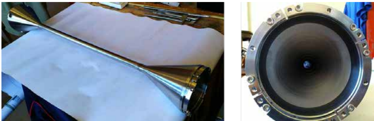
Рисунок 5.2 — Фотографии прототипа вакуумной камеры секции ЛСЭ, состоящей из участка регулярной секции, входной и выходной конических частей
