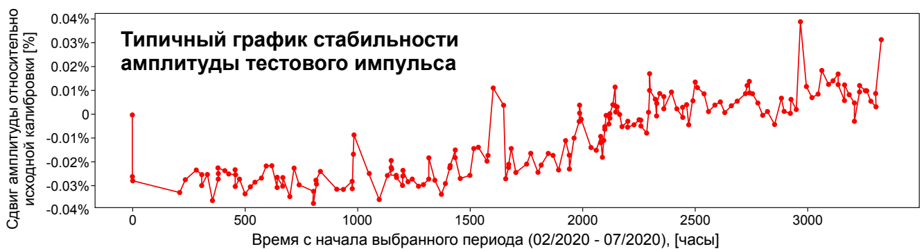
Рисунок 24 — Сдвиг амплитуды относительно исходной калибровки как функция времени. Рост амплитуды объясняется понижением температуры ЕСЛ на 1^{\circ}\text{C}
