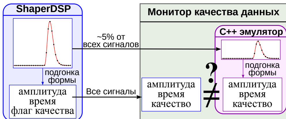
Рисунок 29 — Схема процедуры для проверки алгоритма реконструкции параметров сигнала
