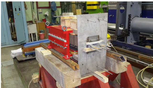
Рисунок 1.12 — Слева — шихтованный дипольный магнит, установленный на стенде магнитных измерений. Справа — зависимость вертикального магнитного поля поворотного магнита от продольной координаты при токе 10 А
