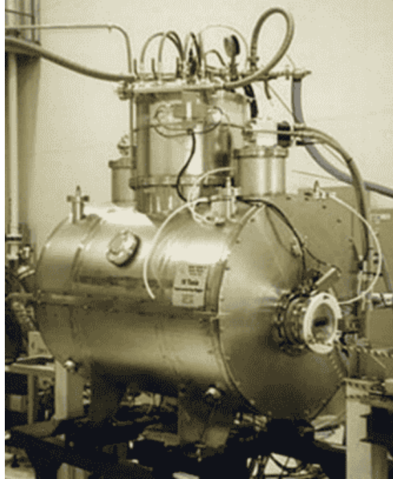
Рисунок 1.9 – Сверхпроводящий шифтер с магнитным полем 10 Т - Wavelength Shifters (производства ИЯФ СО РАН), используемый в SPring-8. Устройство имеет самую высокую напряженность магнитного поля в мире [19]
