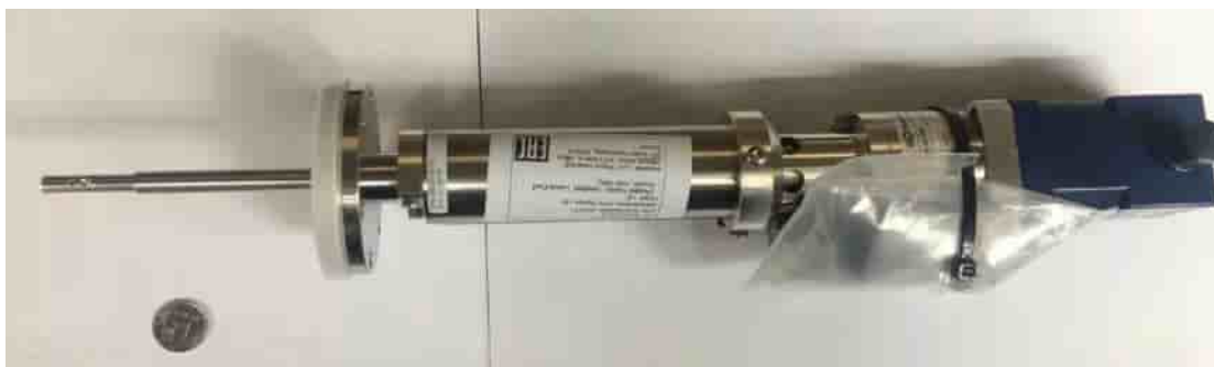
Рисунок 2.13 – Внешний вид линейного актуатора САНВ-10
