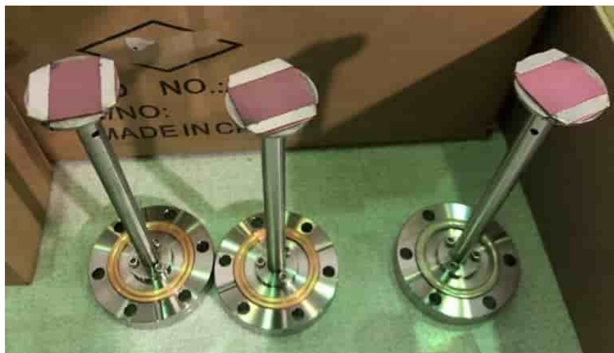
Рисунок 2.16 – Три люминофорных экрана с фланцами перед установкой в магнитном спектрометре
