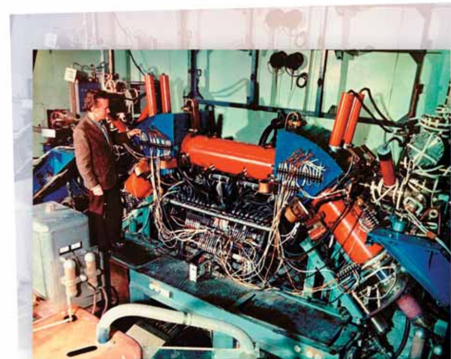
1976 год. Сердце комплекса НАП-М – реализующая метод электронного охлаждения установка ЭПОХА (установка с Электронным Пучком для ОХлаждения Антипротонов). На снимке – один из ее создателей В. И. Куделайнен
